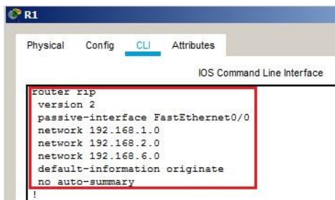
Рисунок 254 – Настройка маршрутизации по протоколу RIP v2
