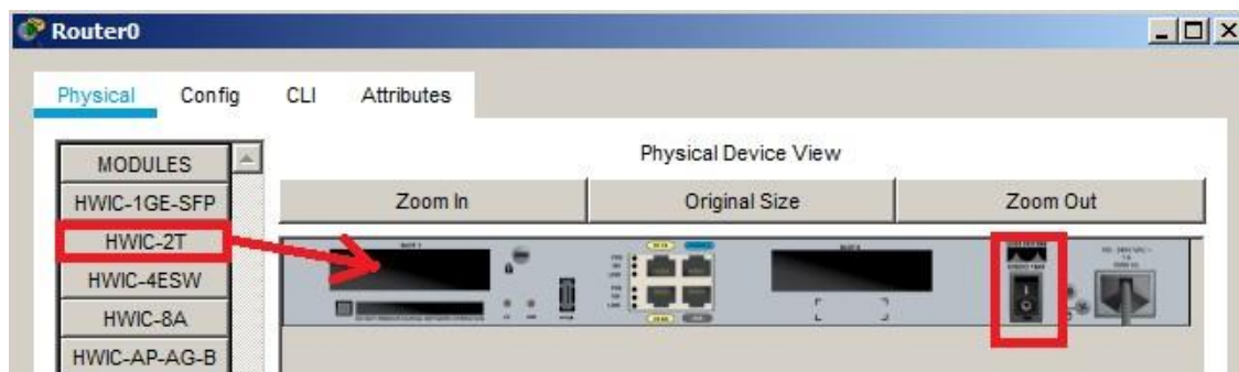
Рисунок 253 – Добавление модуля на Router
