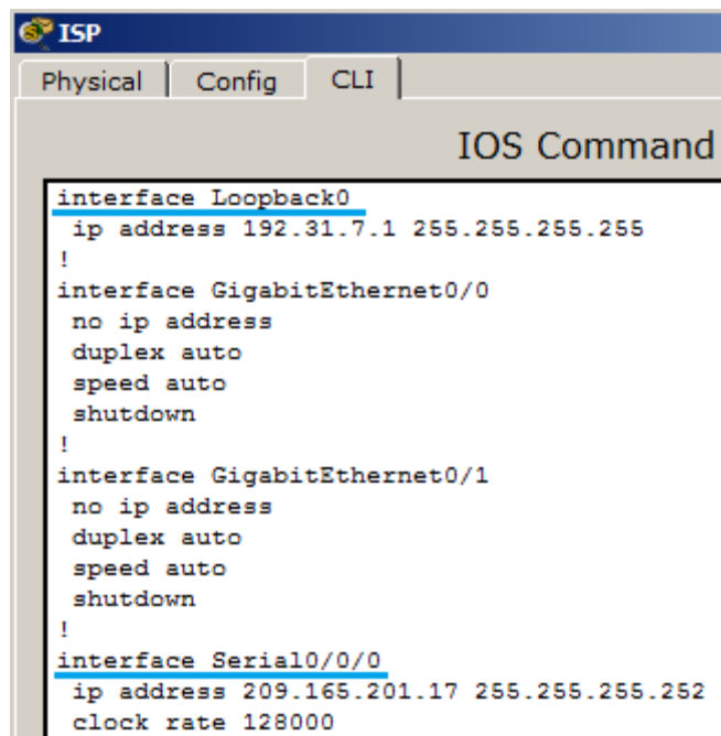
Рисунок 15 – Базовые настройки маршрутизатора ISP
