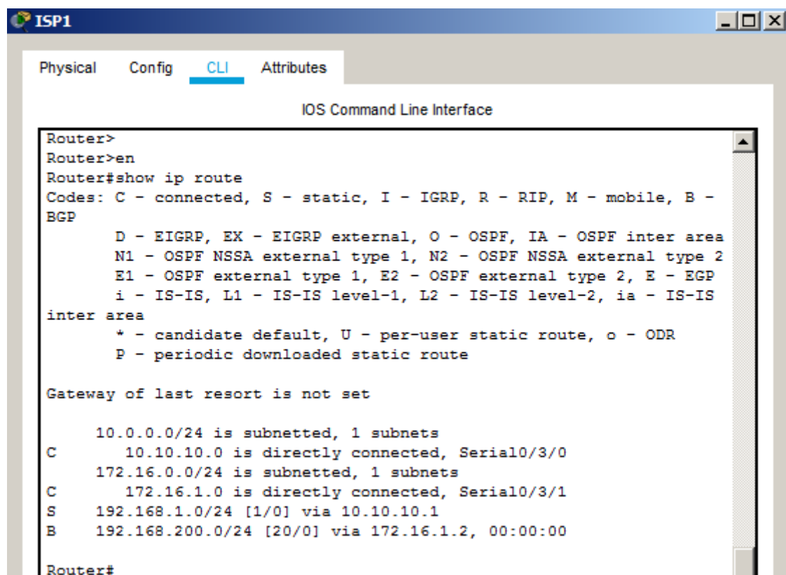
Рисунок 288 – Проверка таблиц маршрутизации ISP1
